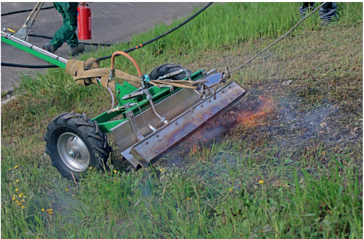
Abb. 4: Speziell entwickeltes, mobiles Abflammgerät im Eigentum der gGmbH zum Einsatz bei der Flächenpflege (Foto: S. Sändig).
